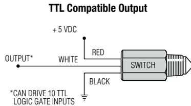
\*CAN DRIVE 10 TTL LOGIC GATE INPUTS
